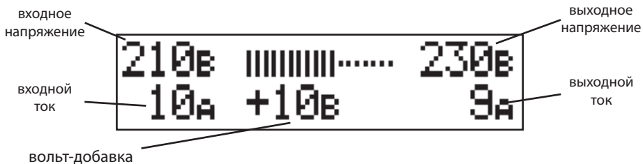
Рис. 11. Вид ЖК-индикатора в режиме изменения выходного напряжения
