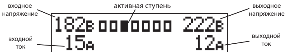
Рис. 10. Вид ЖК-индикатора в режиме ступенчатого регулирования
